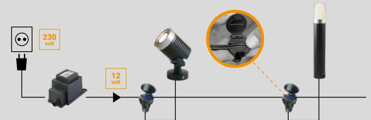
Avec les câbles principaux Flex, vous pouvez décider vous-même où vous voulez connecter les lampes au câble. Il vous suffit de placer le connecteur Flex femelle sur le câble à l'endroit souhaité. Ouvrez le connecteur, introduisez le câble et fermez le clapet. Ensuite, connectez le câble de la lampe au connecteur Flex femelle.
